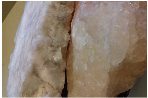
Figuur 6. Links een brok NaCl dat in één van onze testen is gesmolten en weer gestold. Rechts een brok NaCl (Permisch Zechstein) uit Asse II, een zoutmijn in Duitsland.
