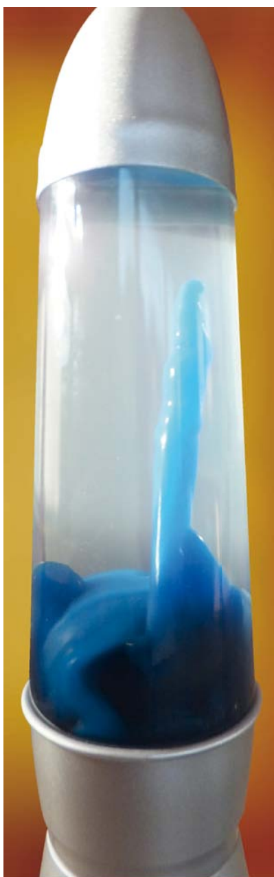
AFBEELDING 3: | De vloeistof in een lavalamp stijgt op, als gevolg van dichtheids-verschil.
